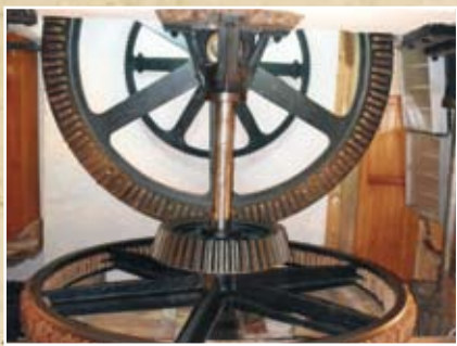
Sur l'axe de la roue à augets, une couronne métallique à dents de bois actionne une roue dentée tronconique entraînant les meules et les accessoires.
